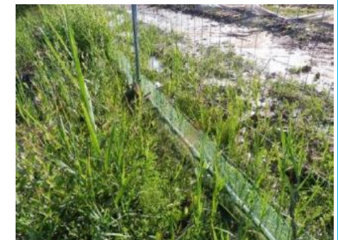
Figure 18 : barrière à amphibiens en doublement d'une barrière de mise en défens
