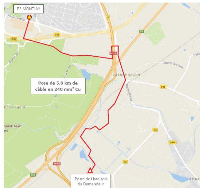
Figure 9 : Tracé prévisionnel de la solution de raccordement
